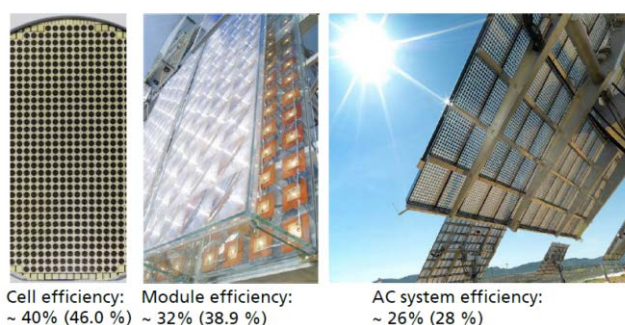
図 1 5 HCPV セル、モジュール、システムの研究段階および実用レベルの効率の現状 (Dr. A. Bettt 提供)
